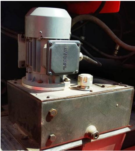
Otomatik yatak yağlama sitemi
